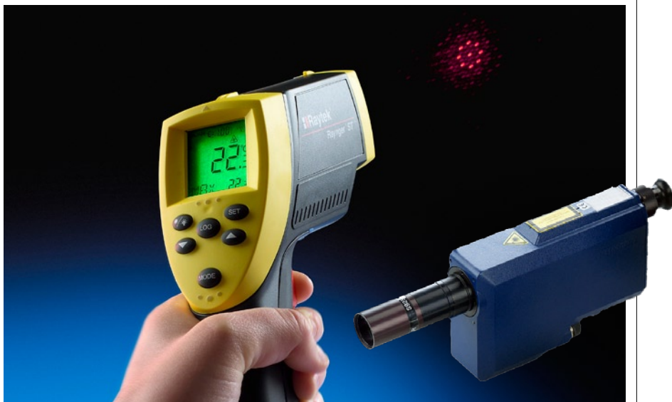
Industriella IR-pyrometrar byggs, likt en systemkamera, upp av utbytbara högkvalitativa komponenter för anpassning till en speciell mätuppgift och –miljö, medan lågprissortimentets handhållna eller enkla processpyrometrar är anpassade till mycket begränsade uppgifter i snäll mätmiljö.
