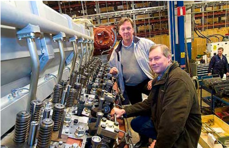
Stefan Söderlund och Lennart Andersson framför en marinmotor under renovering. Med nytt styrsystem och specialutvecklade temperaturgivare blir en renoverad motor från Wärtsilä lika effektiv som en nyttillverkad.
