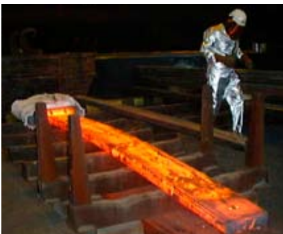
Pentronic har på kort tid levererat flera resande loggrar från Datapaq till svenska stålverk. Paketet på det glödande stålet är en barriär innehållande loggar.
