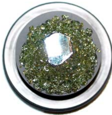
En skiva kiselkarbid under tillväxt. Resultatet är underlag för framtidens elektronik och vackra smycken.
