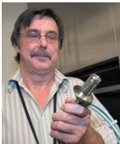
Leif Strömfelt visar genomföring som även sätter stopp för den teoretiska risken att virus och bakterier ska komma ut ur autoklaven.
