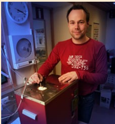
Laboratoriechefen Lars Grönlund provar en givare i en fixpunktsugn.
