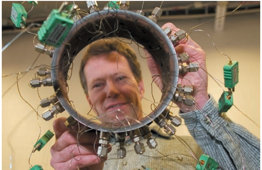
Vid varje prov mäts temperaturen i katalysatorn med en stor mängd tunna termoelement. Lars Johansson på Johnson Matthey visar hur det kan se ut.
