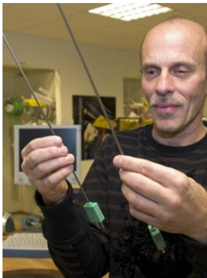
– Se till att givare och skyddsror är tillverkade av ett material som klarar miljön, säger Boije Fridell som flera gånger sett hur fel material leder till att givare fräts sönder på några veckor.
