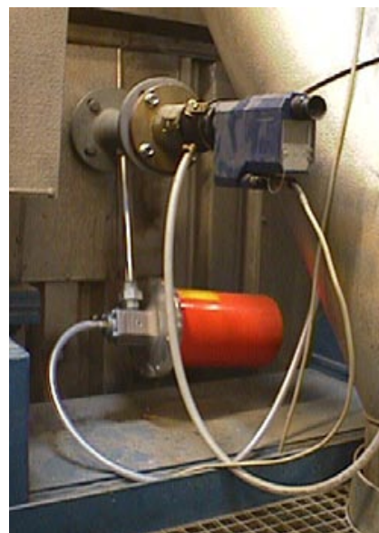
Heitronics har utvecklat IR-pyrometrar för rökgasmätning vid förbränning i tuffa miljöer. Den röda behållaren ingår i systemet för siktfältsrengöring.
