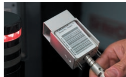
Varje temperaturgivare är individuellt kalibrerad. Streckkoden ger systemet en korrektionsfaktor.
