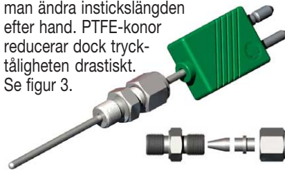
Figur 3. En trycktät genomföring kan underlätta monteringen av givare. Pentronics genomföringar består av kropp, kona, och i vissa fall tryckbussning samt överfallsmutter som ger klämkraft.
