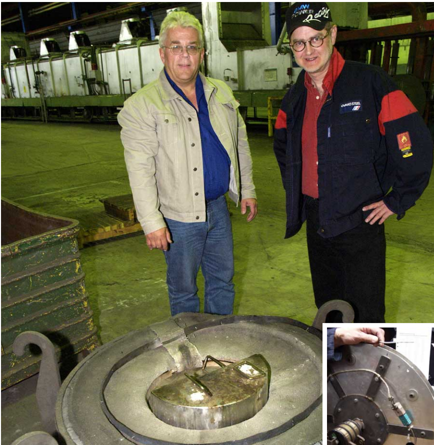
Thomas Ånger och Morgan Holst vid Ovako Steel i Hällefors konstaterar att den resande loggern tjänat ut. Elektronikenheten placeras i en ficka mellan de inre värmebarriärerna. Infällt syns ett upprullat släp-termoelement som är den alternativa mätmöjligheten.
