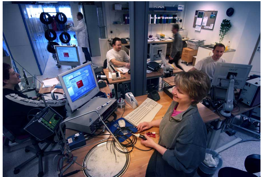
Alla givare som tillverkas hos Pentronic kontrolleras före leverans, de flesta enligt anpassade kontrollprogram som följer kundens kvalitetssystem.
