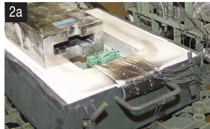
Loggern (2b) går att använda i höga temperaturer om den kapslas in i lådor med värmebarriärer (2a). Barriärernas uppgift är att fördröja värmens inträngande tillräckligt länge för att resan genom ugnen och mätningen ska hinna avslutas. Idag finns radioöverföring av mätdata för realtidsstudier.
