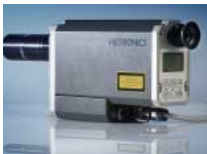
Heitronics KT19.69 i laboratorieutförande.
