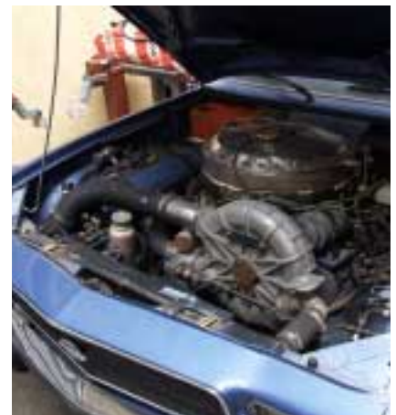
För 30 år sedan gjordes flera och lyckade försök med Stirlingmotorer i bilar. Hårdare miljökrav kan göra motorn aktuell igen.
