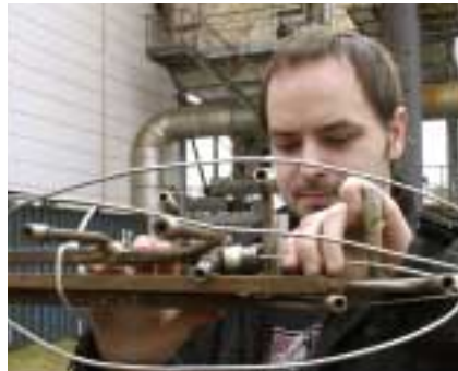
Peter Nyqvist, LiTH, lossar tre sugpyrometrar från biltaket och begrundar hur dessa kommer att inverka på mätresultatet.
