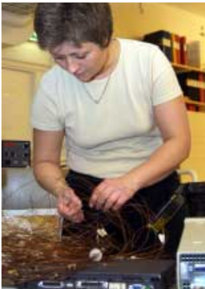
Ann-Charlotte Lindahl förstärker spetsarna på trådtermoelementen för att hindra avbrott.
