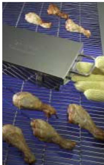
Datapaqs logger är utformad för att följa med kycklinglären under stekningsprocessen. Därmed valideras att innetemperaturen blir tillräcklig för säker konsumtion.
