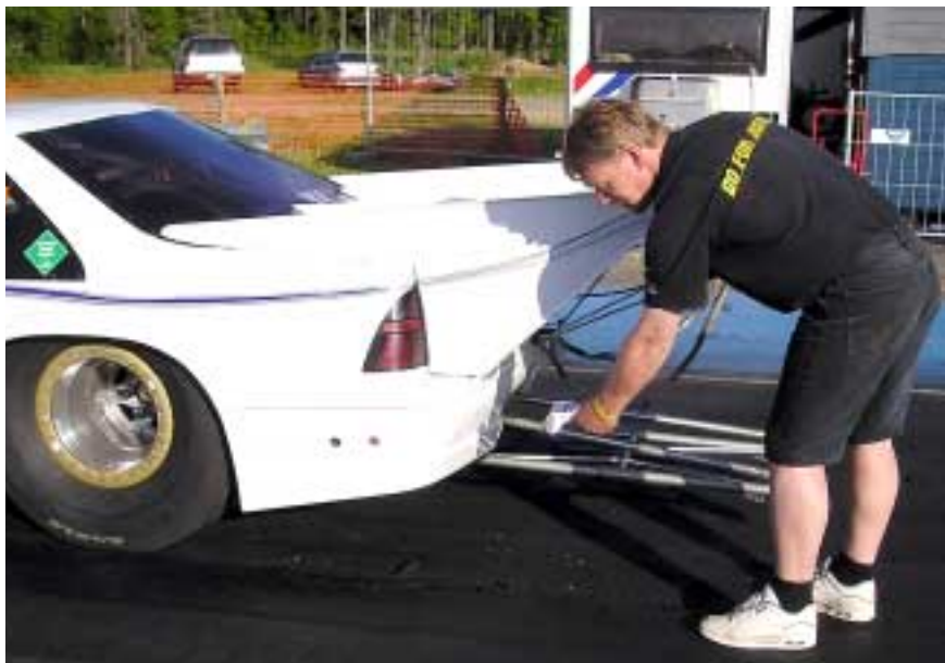
– Vi mäter temperaturen på vägbana och drivande däck strax före varje dragracinglopp, säger Erik Zettervall. Med hjälp av mätvärdena från IR-pyrometern anpassar vi motoreffekten för maximalt väggrepp.
