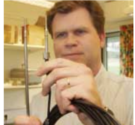
Givaren till vänster är referens och den till höger processgivaren som kalibreras. Båda har spetsar med samma form och fysiska egenskaper.
