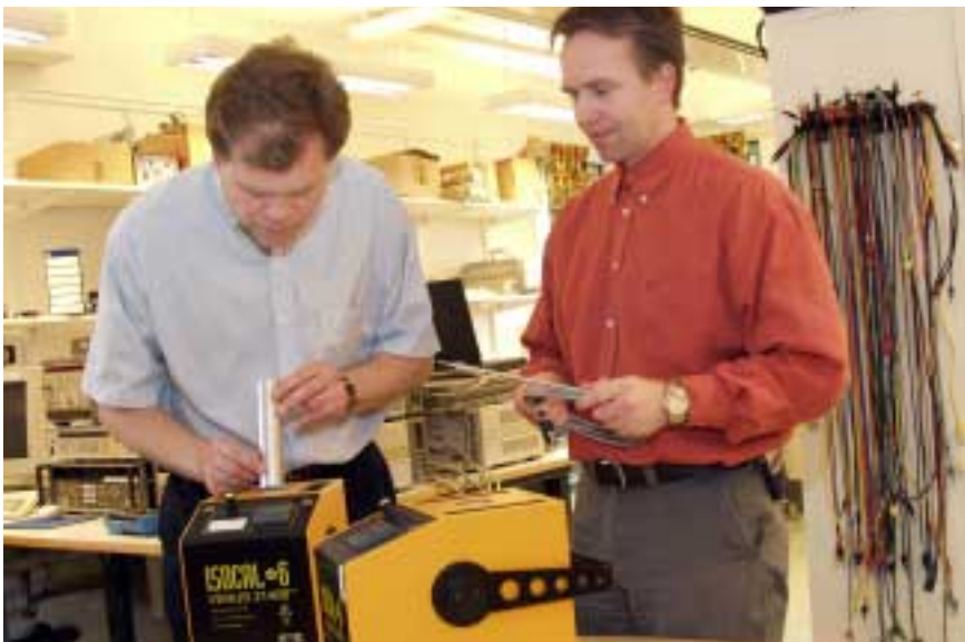
Ricky Möller (t v) sticker ned den insats som Tetra Pak utvecklat speciellt för kalibrering av temperaturmätningen i processutrustning. Richard Nilsson står beredd med referensgivaren som utvecklats för att säkerställa kalibreringen i fält.
