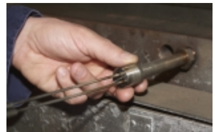
Den specialutvecklade dykfickan gör att manteltermoelementet hamnar på exakt rätt ställe.
