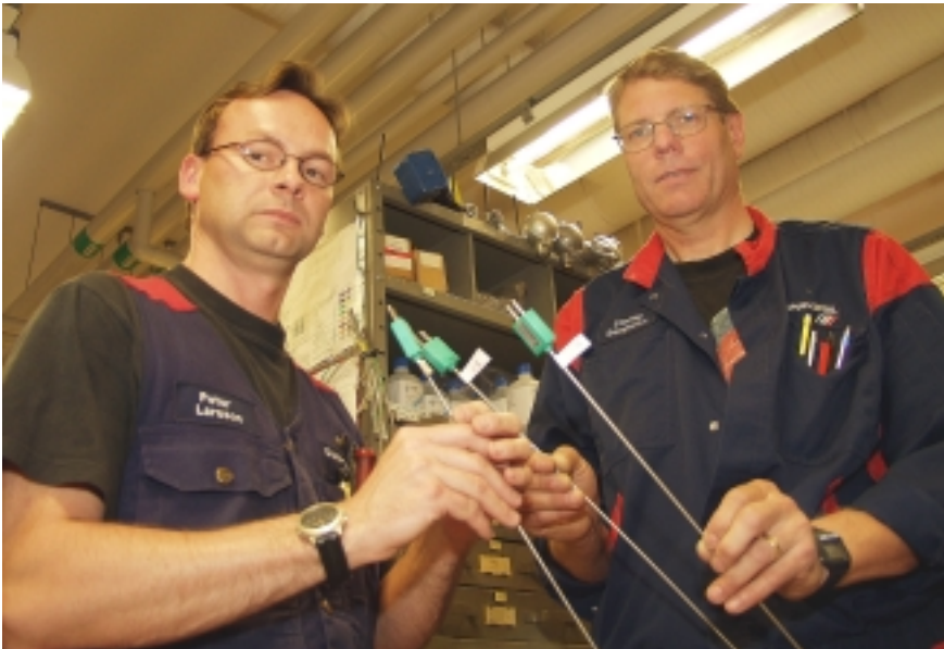
Ordning och reda på Ovako Steel. Här visar Peter Larsson och Staffan Bergström hur varje termoelement märks upp med en lapp som visar avvikelser som fastställdes vid kalibreringen.
