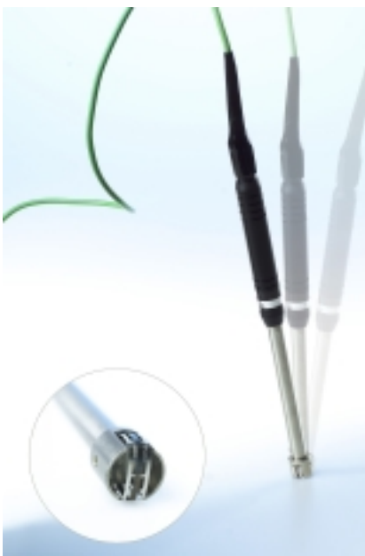
Anritsus yttemperaturgivare är förlåtande mot vinkelfel och varierande anliggningsstryck vid ytmätning.
