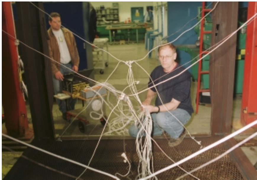
Det går åt 35 termoelement när Björn Nordström och Anders Johansson kontrollerar temperaturjämnheten i en upplösningsugn för aluminium vid Saab Aerospace i Linköping.
