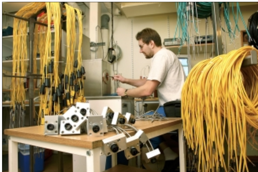
Patrik Lindqvist har fullt upp med att slutkontrollera varje givare med avseende på bl a mätvärde och isolation. De givare som klarar provet förs upp på ett kalibreringscertifikat som följer leveransen till kunden. Om någon givare skulle vara felaktig returneras den till produktionsgruppen.
