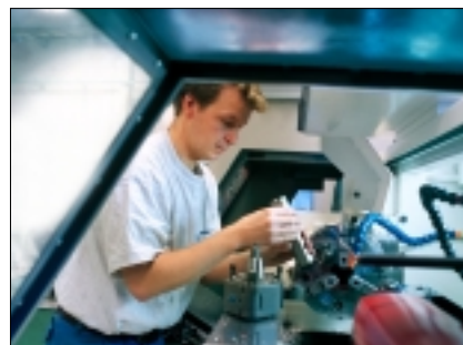
Den NC-styrda supportsvarven fyller hålet mellan enstyckstillverkning i supportsvav och storskalig produktion i de NC-styrda maskinerna.
