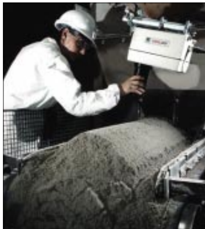
MM 55 Plus är något så ovanligt som en IR-mätare som är färdigkalibrerad när den levereras. Det enda som krävs är justering i en punkt.
