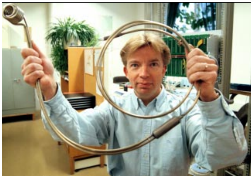
Håkan Johansson på MPC visar en sensor för detektering av slagg. Sensorena tillverkas av manteltermoelement och konstruktionen anpassas till varje enskild installation. Det här är bara en av många typer. Tillverkningskraven är extremt hårda och givarna måste vara hermetiskt täta mot fukt.
