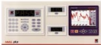
I v syns instrumentet som styr MM 55 Plus, t h en datalogger med skrivare. Allt monterat i 19"-rack.
