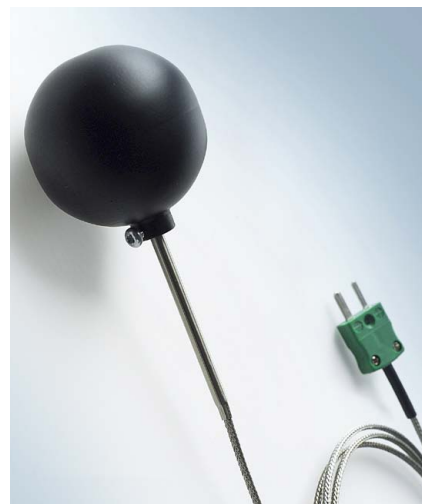
Exempel på en globtermometer (50 mm), här med ett termoelement instuckat till globens centrum. Globtermometern monteras fritt i luften.
