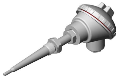
Figur 5. En dykfickas fria del fram till mätspetsen har en resonansfrekvens, ibland flera. Wake-frekvensen av flödet påverkar givaren med svängningstal som beror av konstruktionen, materialet och mätmiljön. Standarden ASME PTC 19.3 TW (2010) beskriver en metod att konstatera om wake-frekvensen är tillräckligt låg för att inte sätta igång förstörande resonanseffekter.
